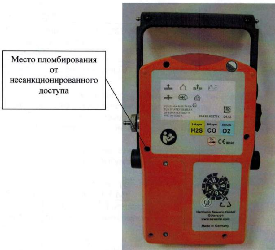
Рисунок 2 - Схема пломбирования корпуса газоанализаторов от несанкционированного доступа (на примере EX-TEC модели HS 680)
